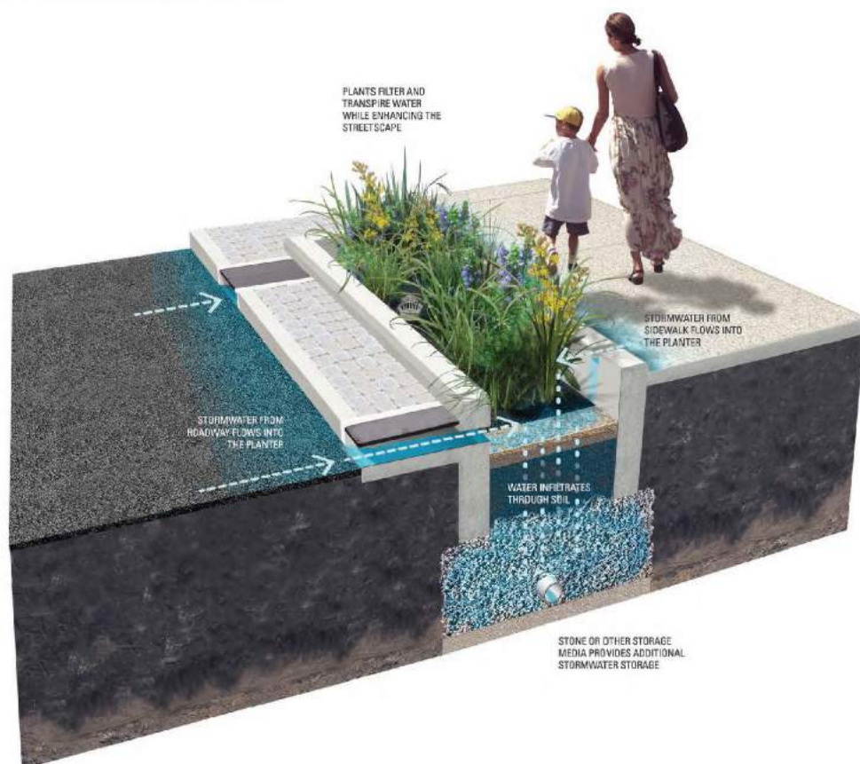
Canteiro Pluvial. Fonte: Copyright 2018 Philadelphia Water Department.
